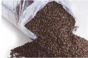
Il sughero da facciata: in pannelli per cappotto, in granuli per riempimento, in lastre sottopavimento
